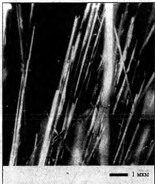
Рис. 5. Віскери кремнію (знімок; під кутом 90° до напрямку росту).
